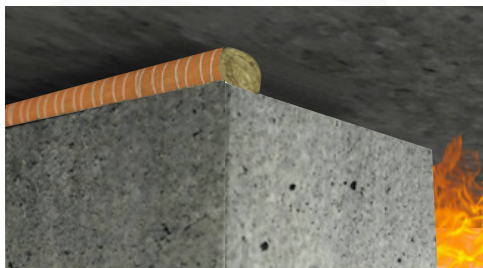
Un cordon côté opposé
